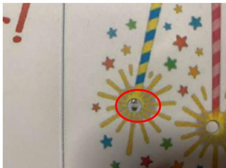
しるしをめやすにして回路図の上に LED 基板をおいて、上からカード本体をかさね、切りぬいた所から LED が見えるようにします。
