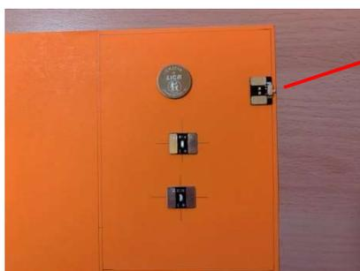
スイッチの凸部分が、カード本体から、はみ出るように配置します
